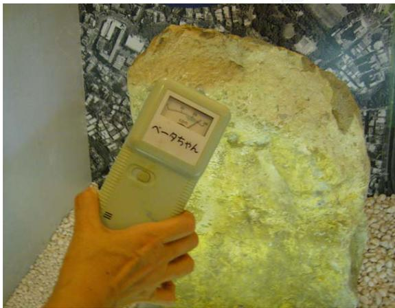
写真16：放射能測定(距離が離れているため測定値は低い)
