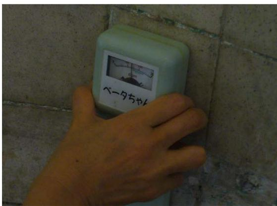
写真18：壁面の放射能はBGの1.5倍程度
