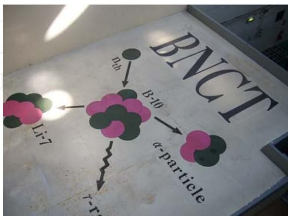
写真 9：原子炉床面に描かれたボロン反応図
